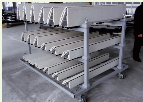
写真・7 テラコッタユニットの搬入
